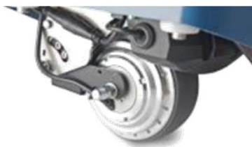
Motorisation de chariot possible avec l'ajout d'une roue électrique
