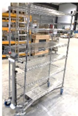
Motorisation de chariot possible avec l'ajout d'une roue électrique
