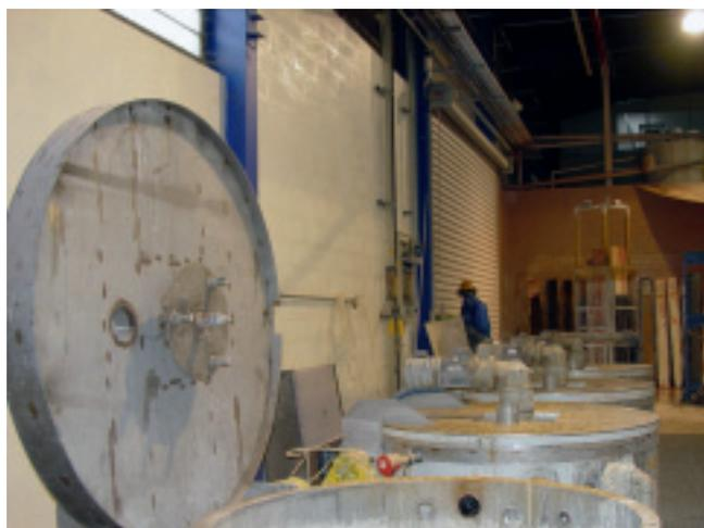
Décapage chimique : cuve avec couvercle et aspiration.
