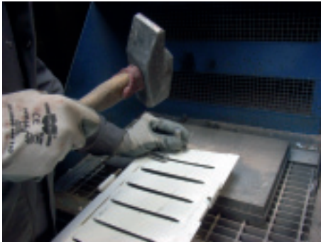
Poste de marquage équipé d'un captage localisé par dossier aspirant.
