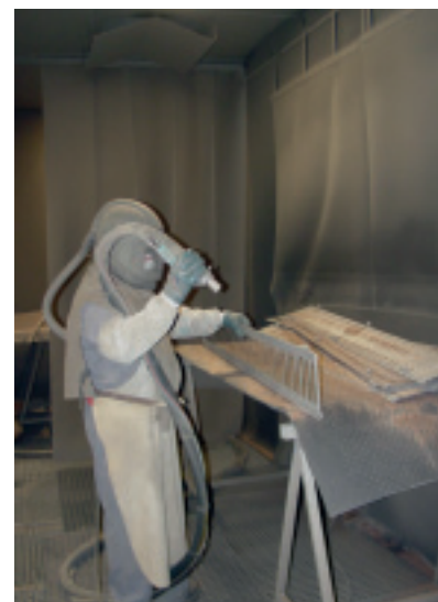
Poste de sablage.
