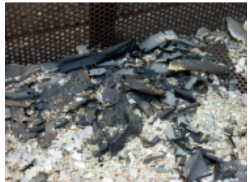
Transport des lames sur des chariots avec un fond en tôle perforée (retient les écailles de peinture).
