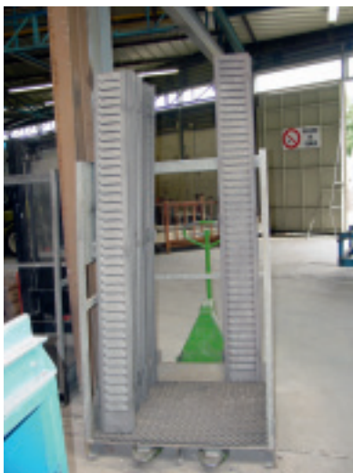
Transport des lames sur chariots avec un fond permettant de recueillir les écailles de peintures.
