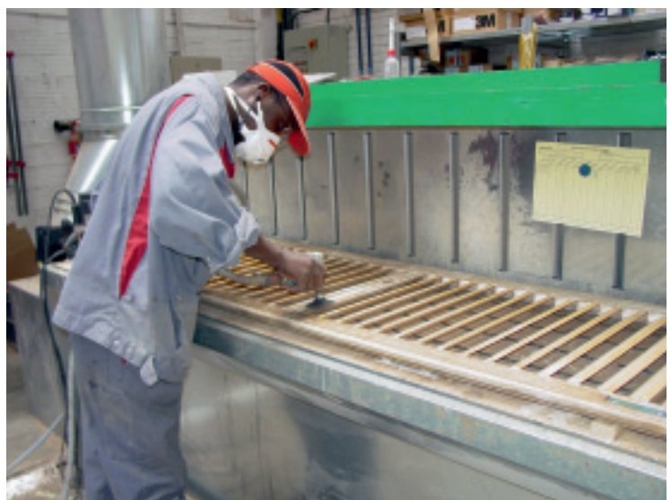
Réparation sur tables avec aspiration.
