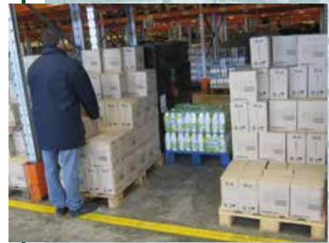
Palettes inférieures à 1,80 m en emplacement de picking.
