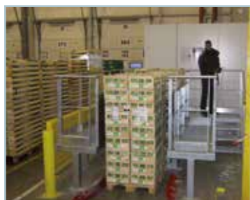
Plate-forme d'écrêtage avec table élévatrice
