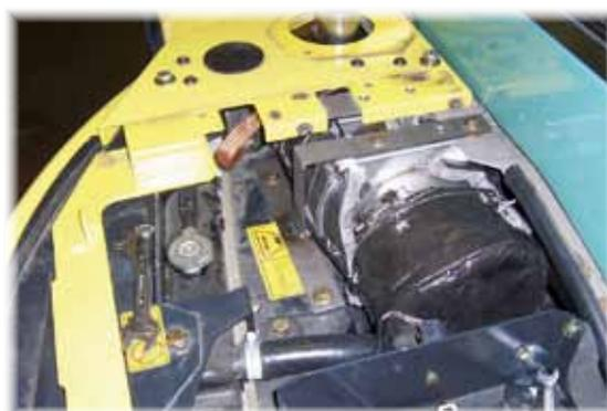
Filtres montés sous le capot moteur
