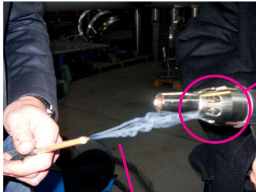
Un **embout de réglage** en bout de buse permet d'affiner le débit en fonction de la pièce à souder, du métal utilisé, etc.
