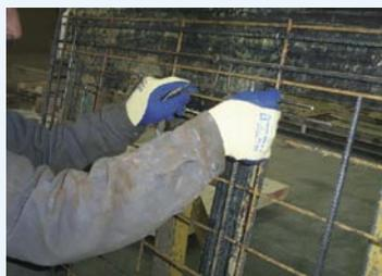
On entend par préparation des armatures toutes les tâches (hors soudure) nécessitant la manipulation des armatures, des inserts de levage, des réservations... afin de façonner, d'assembler et de mettre en place les armatures dans un moule.
