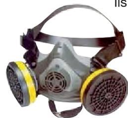
Ils sont constitués d'un matériau souple et étanche et comportent des brides de fixation, des soupapes expiratoires et inspiratoires et un raccord destiné à recevoir un filtre. Une fois en place, ils recouvrent le nez, la bouche et le menton.
