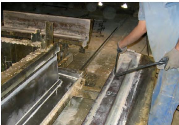
**Fig 5 – Canne de pulvérisation d'un système centralisé**
