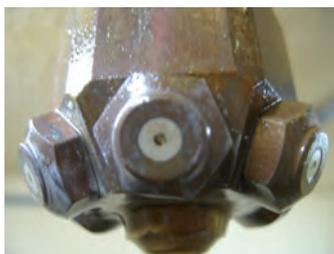
**Fig 3 – Buse à jet conique plein**
